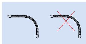
Zu starke Biegebeanspruchung durch Verwendung einer dem zulässigen Biegeradius entsprechenden Rolle oder eines Schlauchsattels vermeiden.
