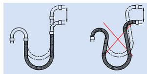
Bewegungsrichtung und Schlauchachse sollen in einer Ebene liegen. Schädliche Torsionsbeanspruchungen werden dadurch vermieden.
