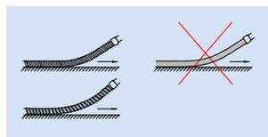
Schlauchleitungen verdrehungsfrei anschließen.
